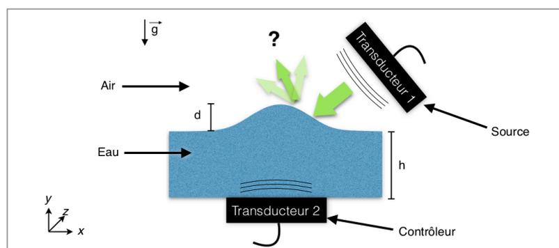
**FIG2 : Schéma de principe du réflecteur acoustique reconfigurable.** Selon le champ émis par le transducteur piézo-électrique 2 noté contrôleur, une interface eau-air (par exemple) est déformée sous l'effet de la pression de radiation acoustique. Cette déformation va modifier la réflexion de l'onde émise par le capteur 1 noté source.
