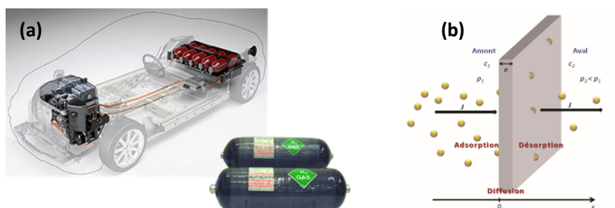
FIG1 : (a) Réservoir à hydrogène pour le domaine automobile. (b) Le matériau polymère constituant le réservoir doit avoir des propriétés barrières au gaz H 2 .
