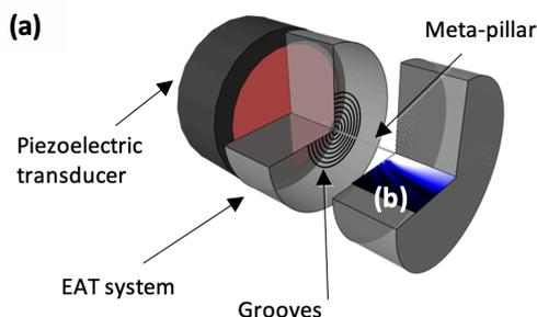
**Fig1. Schéma de principe du dispositif**
