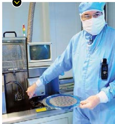
*Les nano-puces sont déposées sur une plaque de silicium. Ces composants technologiques mesurent 500/250 microns, soit l'épaisseur de 8 cheveux.*
